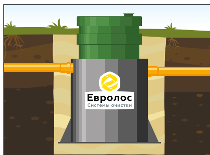
«Евролос ПРО» с удлиненной горловиной — используется при выходе коллектора из здания на глубине до 1,2 м по низу трубы.
